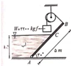
مثال ۹: در شکل مقابل ارتفاع  $h$  چقدر باشد تا دریچه به حالت تعادل قرار داشته باشد؟ از نیروی اصطکاک و وزن دریچه صرف نظر کنید و عرض دریچه را برابر ۳ متر در نظر بگیرید.
