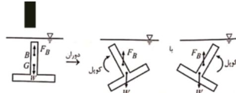
۲- تعادل ناپایدار: اگر مرکز ثقل جسم غوطه ور بالای مرکز شناوری باشد. در این حالت اگر تغییر شکل زاویه‌ای کوچکی در جسم پدید آید، گشتاور حاصل از کوپل نیروی وزن و نیروی شناوری، باگرداندن جسم در جهت دوران ایجاد شده، به ادامه دوران کمک خواهد کرد.
