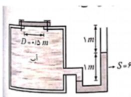
مثال ۲: در شکل مقابله یک درپوش دایره ای به جرم  $150 \text{ kg}$  ای محکم شده است. نیروی کششی ایجادشده در هر یک از پیچ ها چند نیوتن است؟ ( $g = 10 \text{ m/s}^2$ ,  $\pi=3$ )
