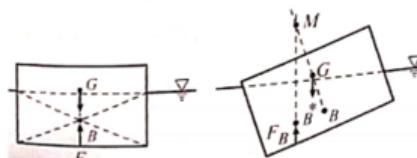
مثال ۱۷: مخروط توپری به وزن مخصوص  $\gamma_s$  مطابق شکل در آب به وزن مخصوص  $\gamma_w$  شناور است. حداقل زاویه  $\alpha$  را به نحوی تعیین کنید که پایداری مخروط شناور تامین شود. مخروط همگن است و مرکز جرم آن به فاصله  $H = 0.75$  از راس قرار دارد.
