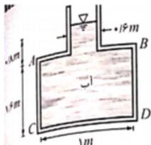
مثال ۱: مقطع ظرفی که در شکل نشان داده شده است، دایره ای می باشد. مقدار نیروی قائم رو به بالا، واردہ به سطح  $AB$  و نیز مقدار نیروی قائم رو به پایین، واردہ به سطح  $CD$  را تعیین کنید. آیا نیروی وارد بر سطح  $CD$  با وزن سیال درون ظرف برابر است؟ چرا؟ ( $\pi=3$ )
