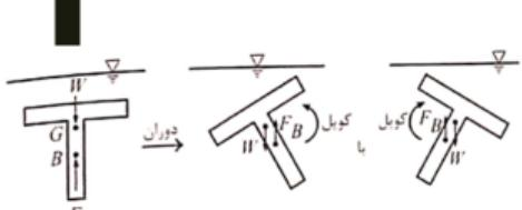
۳- تعادل خنثی: اگر مرکز ثقل جسم غوطه ور منطبق بر مرکز شناوری باشد. در این حالت اگر تغییر شکل زاویه‌ای کوچکی در جسم پدید آید، به همان حالت باقی خواهد ماند و تمایلی به ادامه دوران یا بازگشت به حالت اولیه ندارد.
